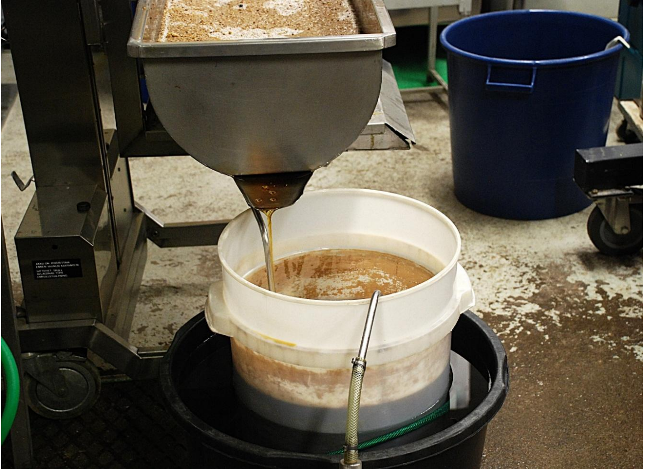
Vierre valuu käymisastiaan, jota samalla jäähdytetään vesikierukan avulla
