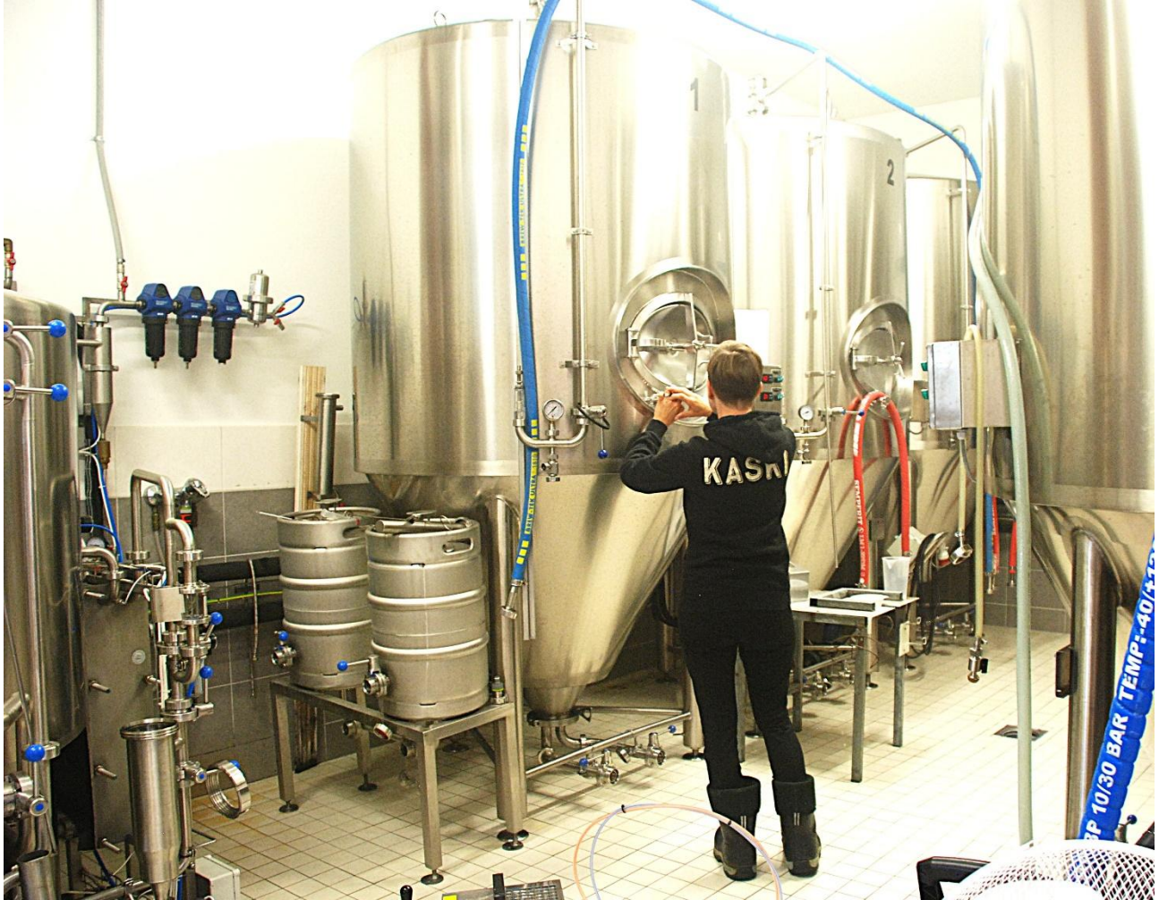
Tankkien lämpötiloja ja painetta säädellään viikoittain
