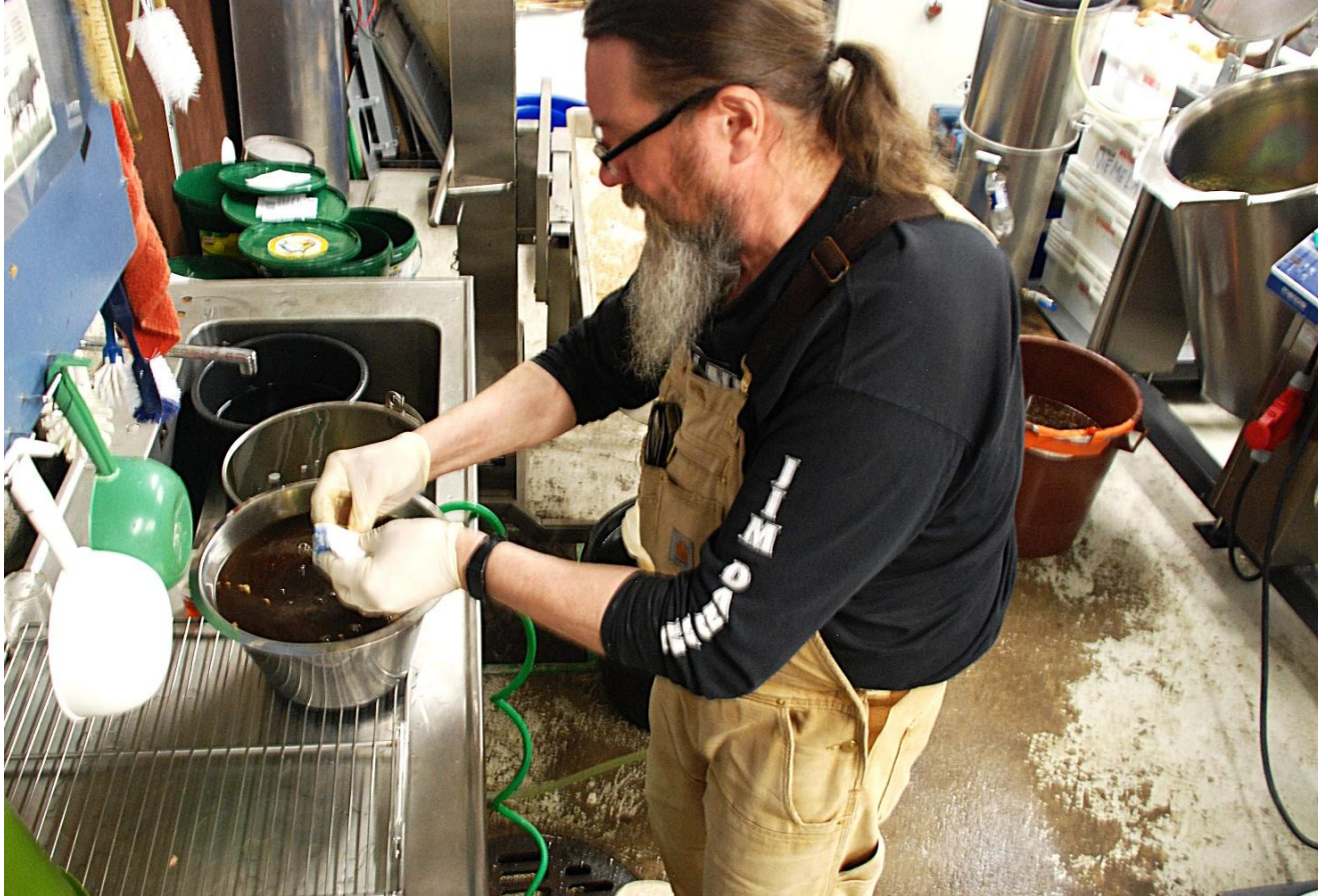
Hiiva sekoitetaan vierteeseen joka on jo jäähtynyt käden lämpöiseksi
