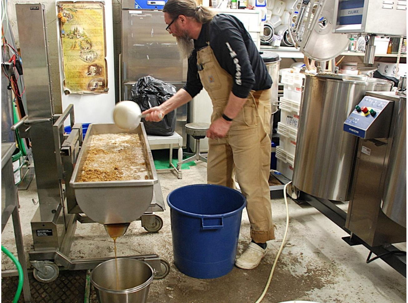
Mäskistä erotetaan vierre kuurnassa
